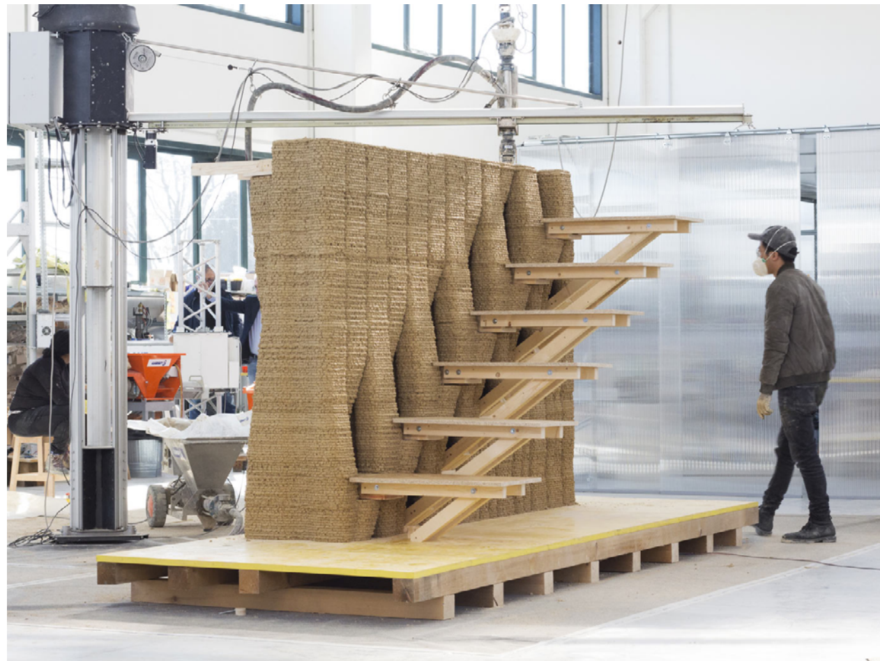
▪ 3D tlačaná stena z hlíny so zabudovaným dreveným schodiskom zdroj: 3dwasp.com / 3D printed earth wall with embedded staircase source: 3dwasp.com
