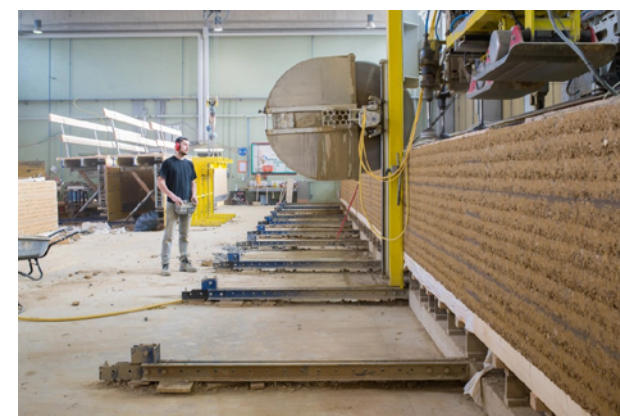
■ automatizovaná produkcia prefabrikovaných stenových panelov z nabijanej hliny zdroj: lehmtone.de / automated production of prefabricated wall panels from rammed earth source: lehmtone.de
