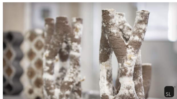
■ aplikácia rastu mycelia v digitálne vyrobených hlinených štruktúrach zdroj: 3dwasp.com / application of mycelial growth within digitally manufactured clay structures source: 3dwasp.com
