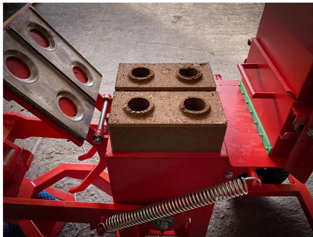
zámková nepálená tehla s prímiesou cementu
